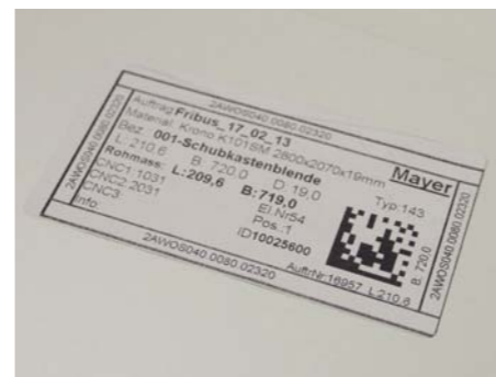
/ Beim Einlauf in die Kantenbearbeitung wird das Etikett automatisch gescannt. Es enthält alle erforderlichen Informationen. Diese Datenbasis...
