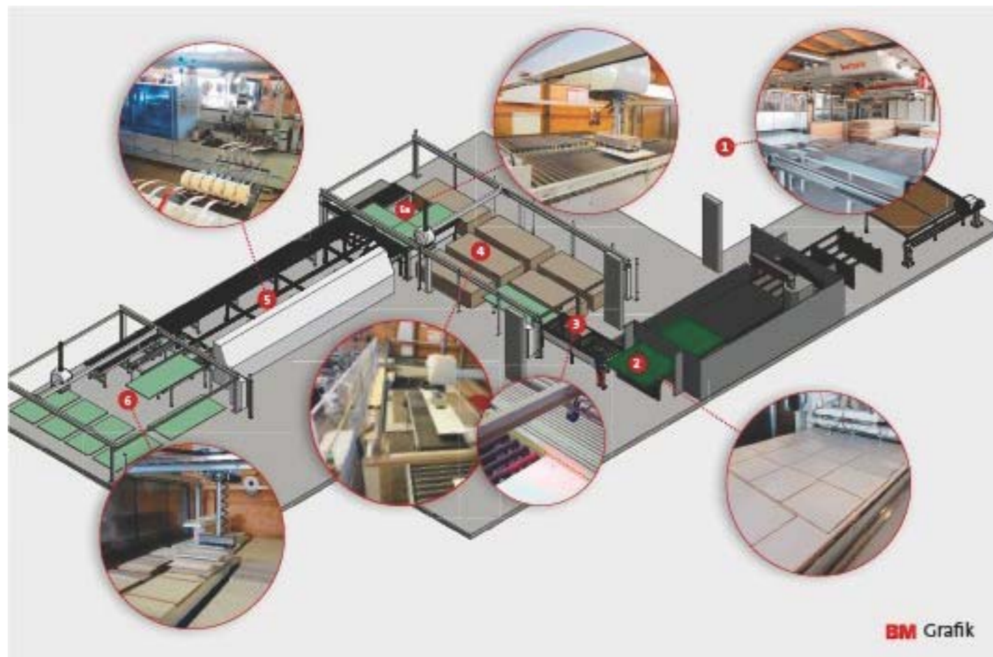
/ Mannlose Kantenzelle bei Mayer. 1: Automatisches Plattenlager (Barbaric) 2: Nestingmaschine (Holz-Her) 3: Automatischer Scan des Teile-Etiketts beim Einlauf in die Anlage 4: Bereitstellung für die Kantenbearbeitung 5: Kantenleimmaschine (Homag) 5a: Rückführung und Übergabe für weitere Kantenbearbeitungen (Barbaric) 6: Vollautomatisches, definiertes Ab stapeln nach der Kantenbearbeitung (Barbaric)
