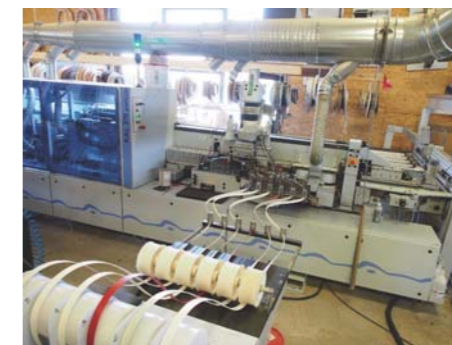
/ ... Datenbasis für die vollautomatisierte Kantenbearbeitung auf der Homag. Die Anlage arbeitet komplett mannlos und schafft 1000 Teile/Schicht.
